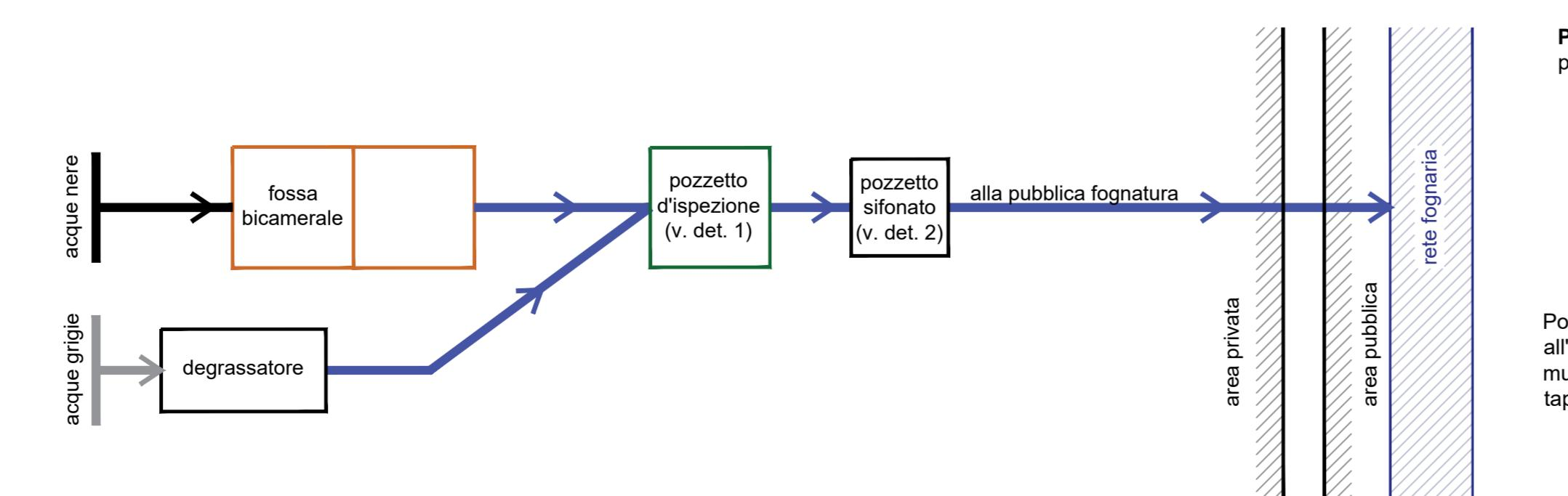
DETtaglio 1 - Allacciamento utenza fognaria - pozzetto d'ispezione
