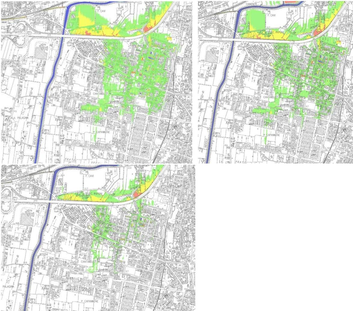
*Scenari di progetto a seguito dell'adeguamento delle arginature del Torrente Nievole*
