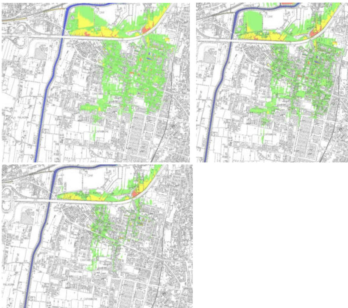
*Scenari di progetto a seguito dell'adeguamento delle arginature del Torrente Nievole*
