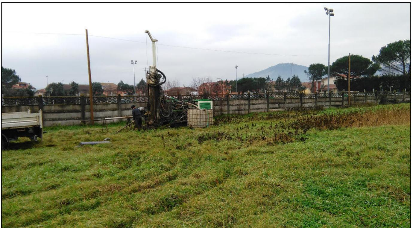
Da 0m a -5m da -1,5m a -2m Campione Indisturbato S2C1. A -3m Campione Disturbato S2C2. SPT da -2m a -2,45m  $N_{SPT}=1/1/0$  - SPT da -3,5m a -3,95m  $N_{SPT}=13/16/15$
