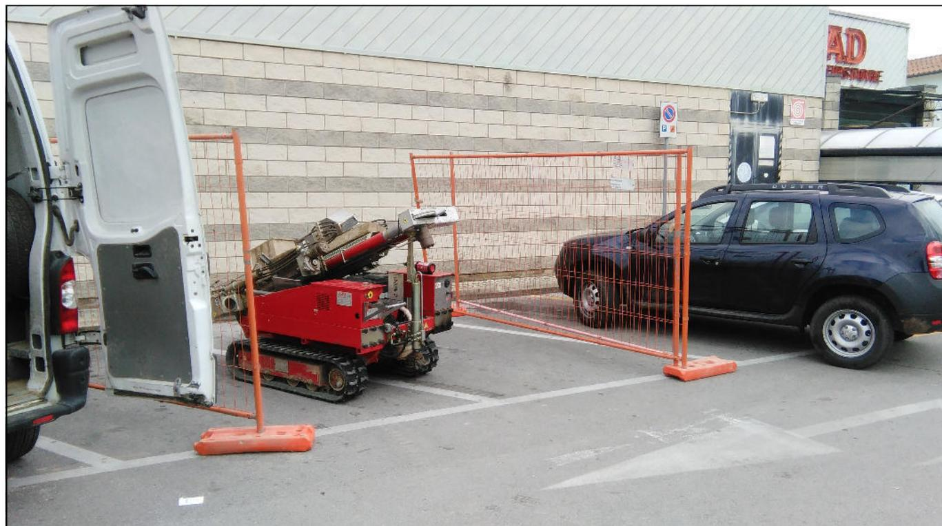
PROVA PENETROMETRICA DINAMICA
